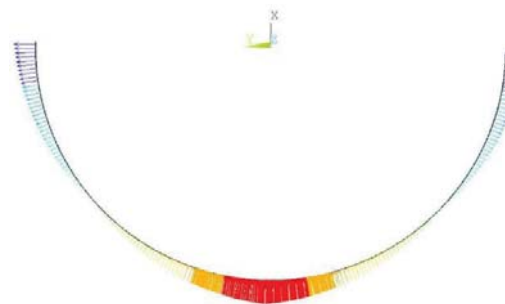
Рис. 3. Эпюра ветрового давления
