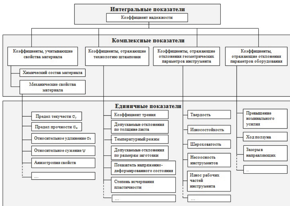
Рис. 1. Структура и содержание показателей надежности технологического процесса листовой штамповки
