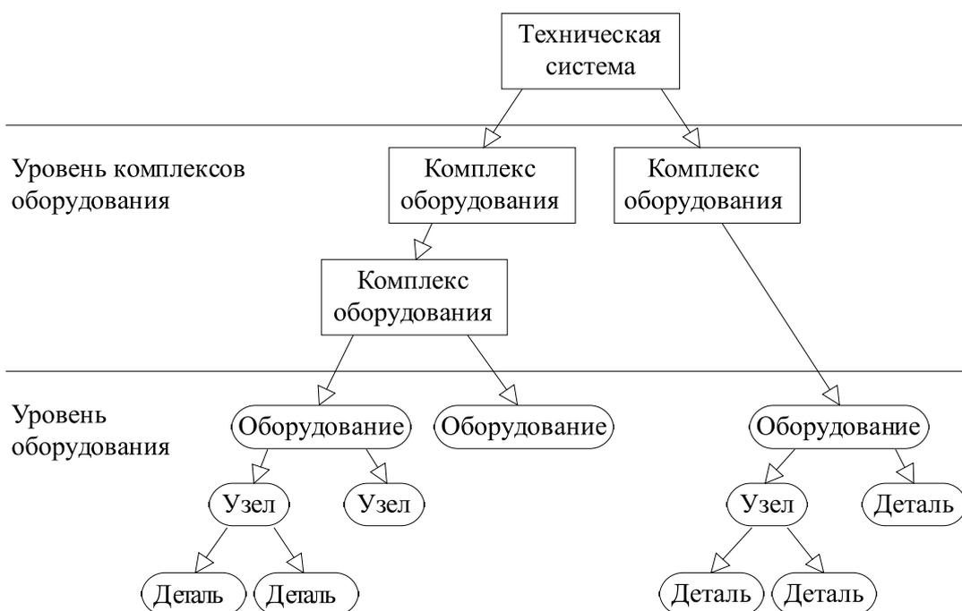
Рис. 1. Иерархическая структура технической системы
