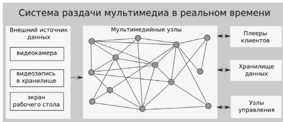
Рис. 1. Элементы системы раздачи мультимедийных потоков
