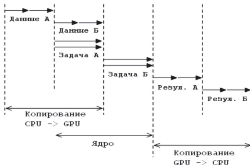
Рис. 2. Диаграмма многопоточного исполнения с перекрытием загрузки данных
