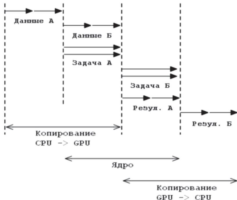
Рис. 4. Диаграмма многопоточного исполнения с перекрытием копирования данных в обоих направлениях
