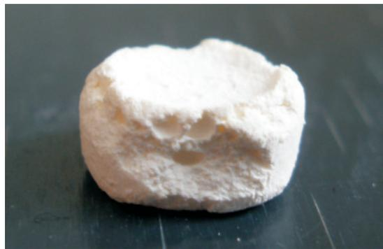
*Образец наномикropористого материала, полученного методом высушивания эмульсии, стабилизированной органо-модифицированным аэросилом. Высота образца примерно 0,5 см; диаметр – 1 см<sup>2</sup>*
