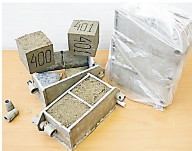
Рис. 2. Образцы до и после извлечения из форм
