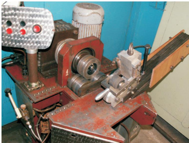
Рис. 2. Установка для раскатки труб с помощью давящего кольца
