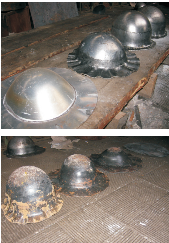
Рис. 4. Фотографии поэтапного формоизменения заготовки, л. 4,0: а – алюминиевого сплава БТА; б – титанового сплава BT14
