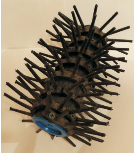
Рис. 1. Фото барабана с гибкими элементами, закрепленными по винтовой линии на его поверхности
