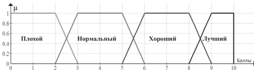
Рис. 1. Функции принадлежности лингвистической переменной «Тип компенсатора»
