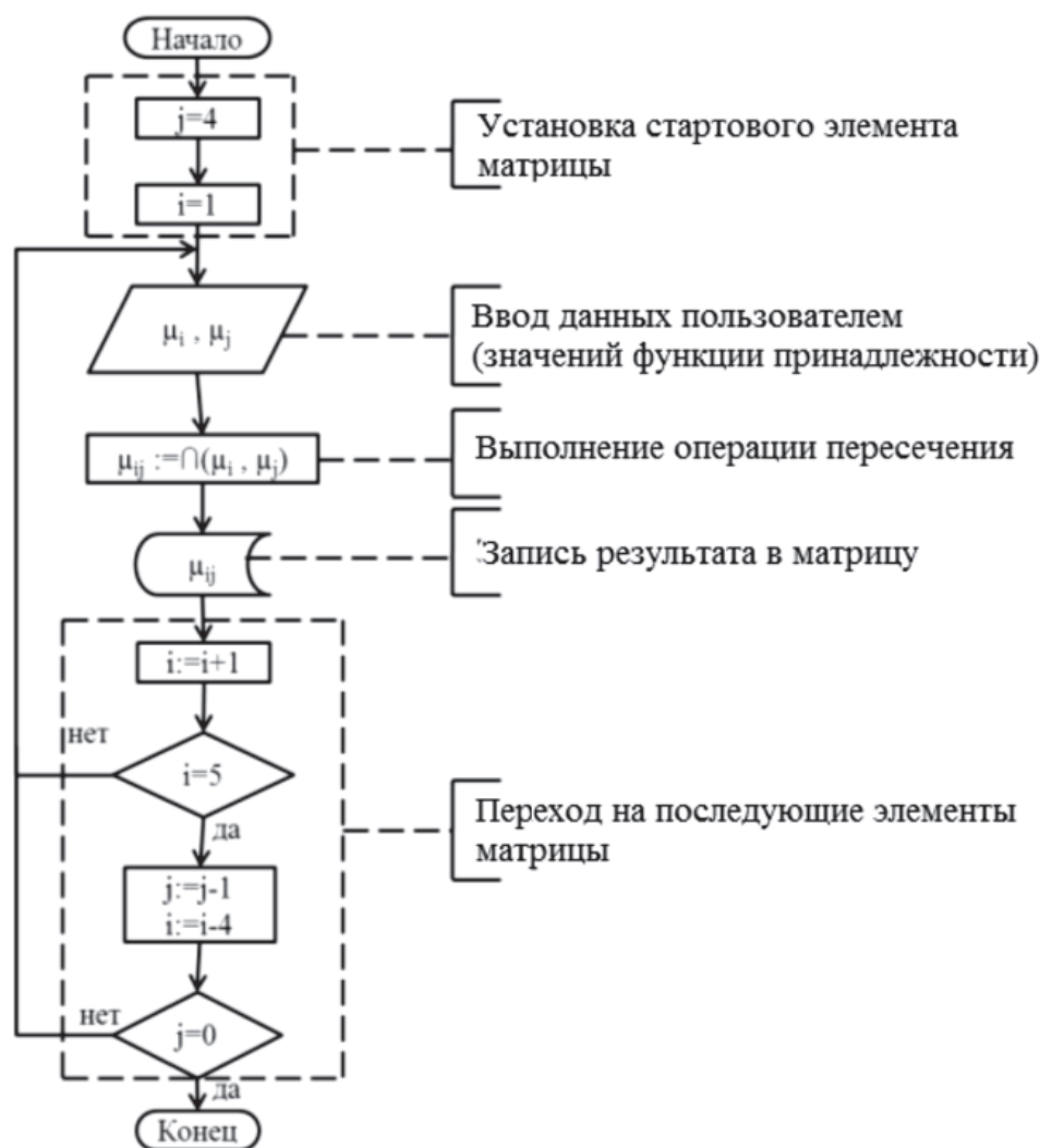
Рис. 4. Алгоритм операции пересечения нечетких множеств в процедуре нечеткого комплексного оценивания
