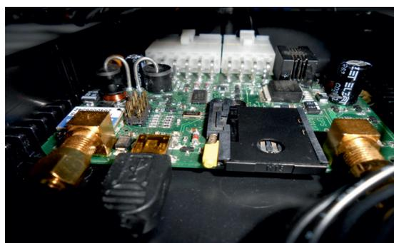
*Рис. 5. Макетный образец с подключенными внешними антеннами GPS/ГЛОНАСС и GSM, разъемом micro USB и интерфейсным разъемом*
