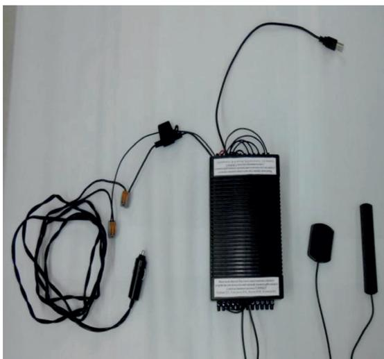
*Рис. 1. Макетный образец бортового навигационно-связного устройства для сельскохозяйственной техники, вид сверху*
