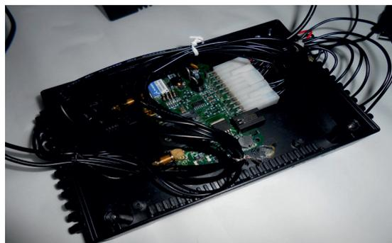
*Рис. 4. Макетный образец бортового навигационно-связного устройства для сельскохозяйственной техники со снятой крышкой*
