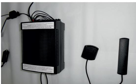
*Рис. 2. Макетный образец бортового навигационно-связного устройства для сельскохозяйственной техники, вид сбоку*
