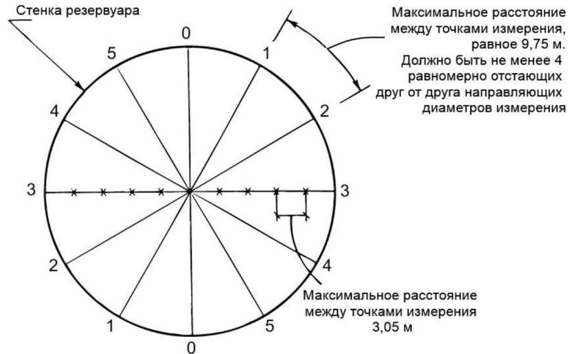
Рис. 1. Требования к геодезическим измерениям дна и окрайки резервуара в API 653
