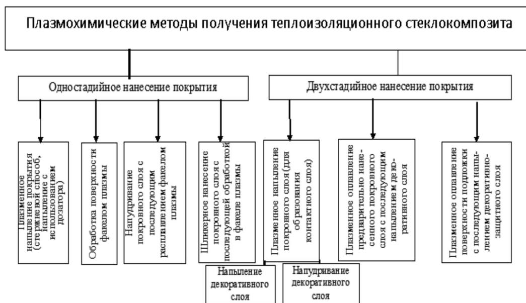
Рис. 4. Плазмохимические методы нанесения покрытий на поверхность пеностекла
