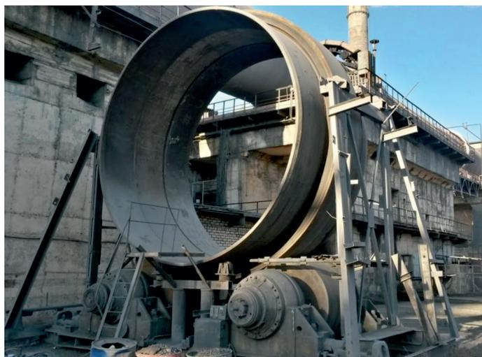
Рис. 6. Бандаж с кольцевыми обечайками на специальном стенде для их сварки
