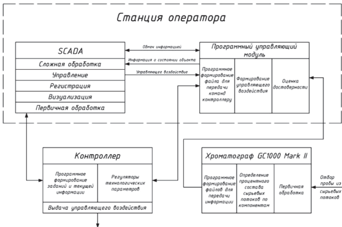
Рис. 4. Структурная информационная система определения состава фракций этаноламина
