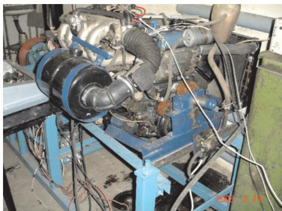
Рис. 1. Исследовательский стенд для испытаний двигателя ЗМЗ-4062
