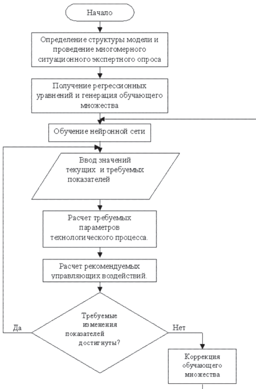
Рис. 2. Блок-схема алгоритма построения и функционирования системы диагностики электролизного производства
