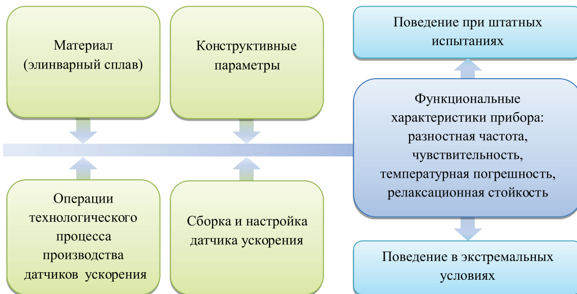
Рис. 3. Причинно-следственная диаграмма оценки факторов, влияющих на функциональные характеристики датчика
