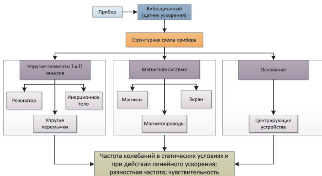
Рис. 2. Концептуальная модель датчика ускорения
