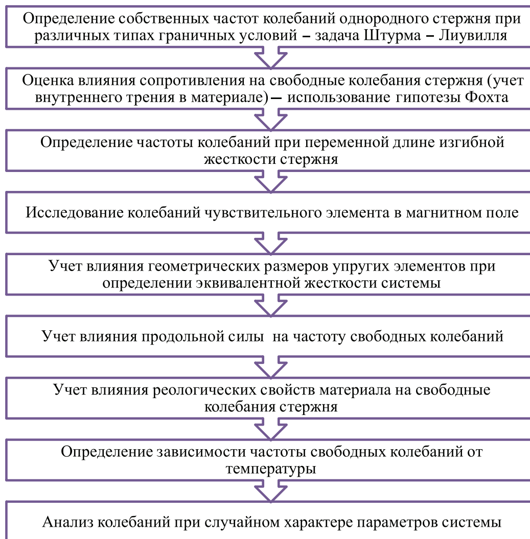
Рис. 4. Процедуры математического моделирования датчика ускорения
