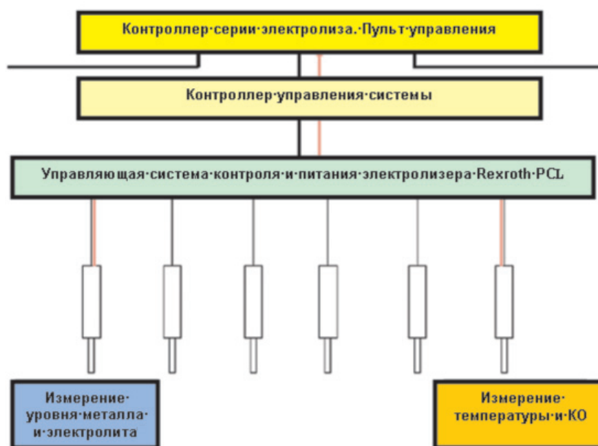
Рис. 3. Управление технологическим процессом через систему питания (АПП)
