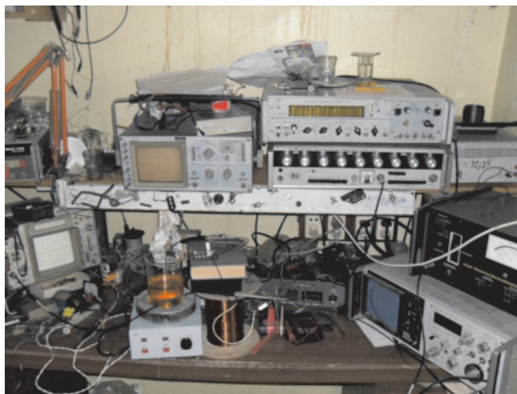
Рис. 3. Общий вид стенда для измерения коэффициента теплопроводности жидкости
