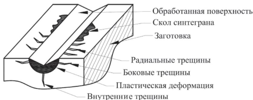
Рис. 4. Схема образования разрушений у синтеграна при обработке резанием
