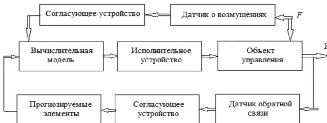
Рис. 2. Структурно-функциональная схема автоматизированной системы управления:  $Y_u$  – целевая функция;  $U$  – управляющее воздействие;  $Y$  – выходной показатель;  $F$  – возмущения
