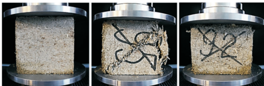
Рис. 4. Вид образцов (слева направо) до сжатия, при сжатии вдоль и поперек слоёв укладки древесно-цементной смеси
