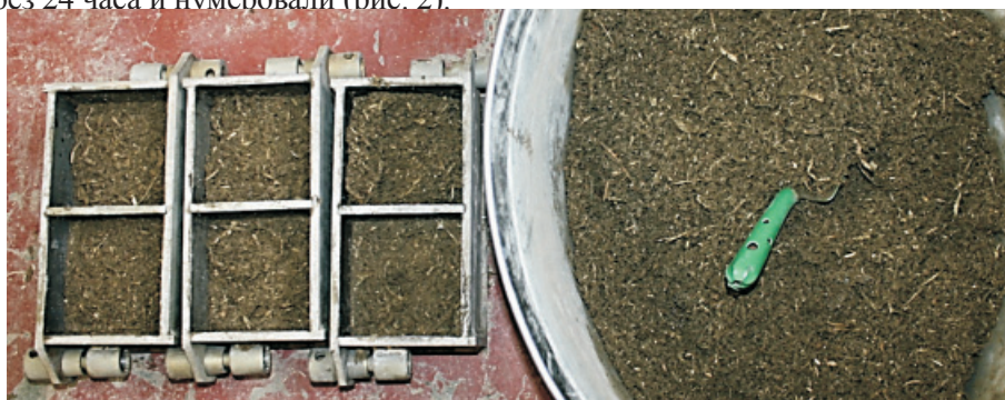
Рис. 1. Заполнение форм древесно-цементной смесью
