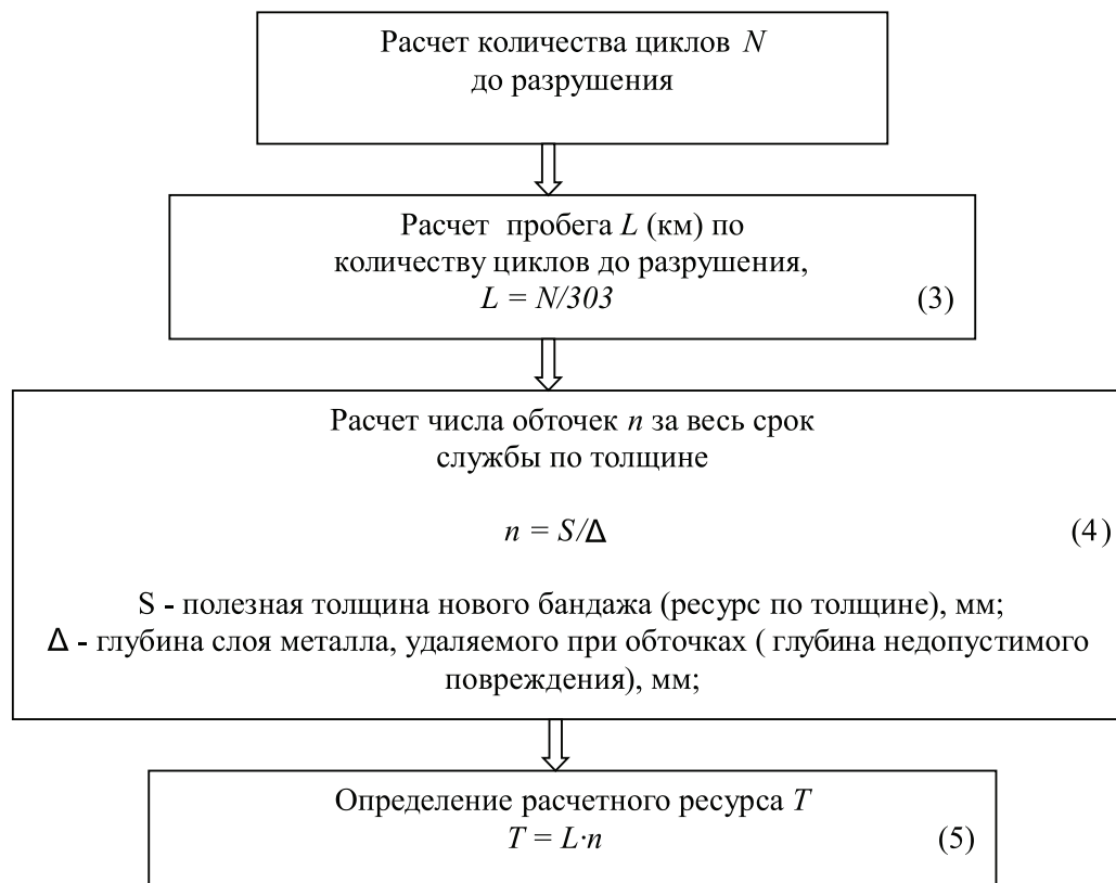
Рис. 3. Алгоритм расчета ресурса бандажа локомотивного колеса
