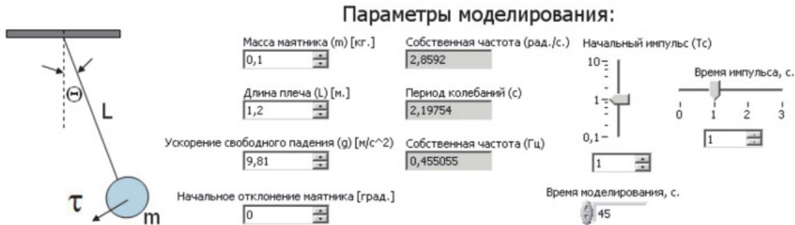
Рис. 1. Ввод параметров моделирования плоского нелинейного маятника на лицевой панели виртуального прибора
