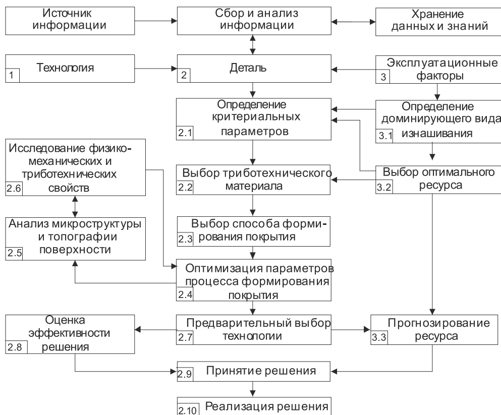
Рис. 2. Блок-схема проектирования ТП упрочнения поверхности трения формированием металлокерамического покрытия
