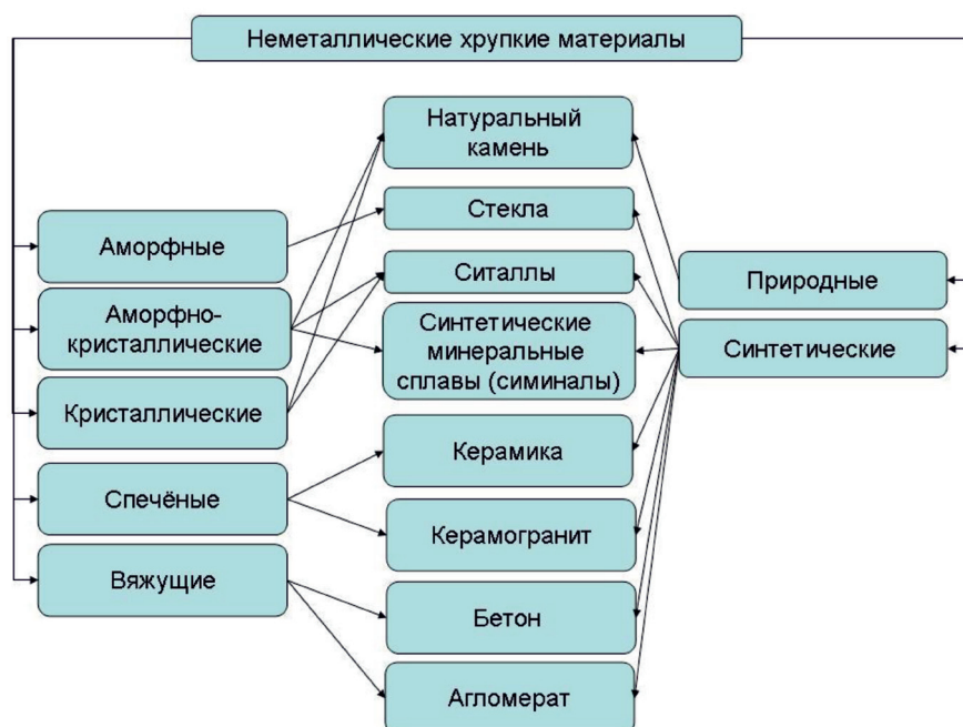
Рис. 1. Прикладная классификация хрупких неметаллических материалов
