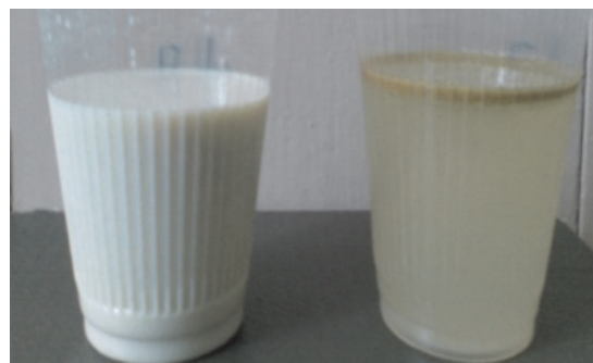
Рис. 2. Отработанная СОЖ до и после подкисления: а – pH = 9 ; б – pH = 3 (после 5 суток)
