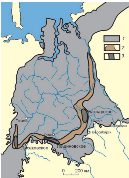
Рис. 1. Схема Западно-Сибирского железорудного бассейна [3, 4]: 1 – площадь распространения мел-палеогенового моря; 2 – полоса распространения прибрежно-морских железорудных отложений; 3 – площади наиболее крупных железорудных узлов (месторождений)
