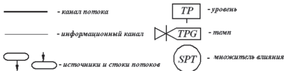
Рис. 1. Обозначения, принятые в модели Дж. Форрестера [5]
