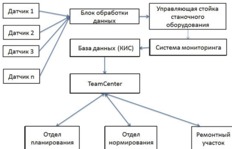
Рис. 3. Схема организации мониторинга оборудования с интегрированной системой
