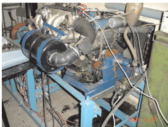
Рис. 1. Исследовательский стенд для испытаний двигателя ЗМЗ-4062
