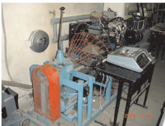
Рис. 1. Исследовательский стенд для испытаний двигателя ЗМЗ-4062
