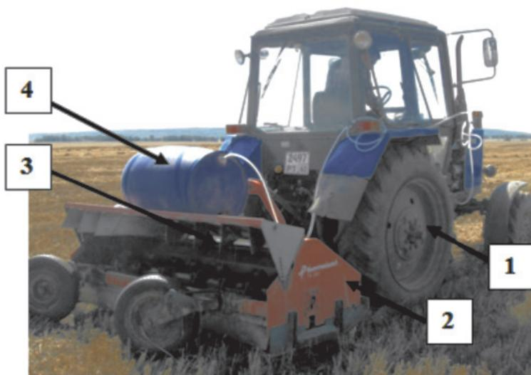
*Устройство для утилизации незерновой части урожая на базе серийного измельчителя-мульчировщика Kverneland fx 230:*
