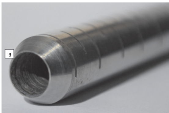
Рис. 2. Внутренний диаметр рабочего корпуса (зубья по типу «рыбьей чешуи»)
