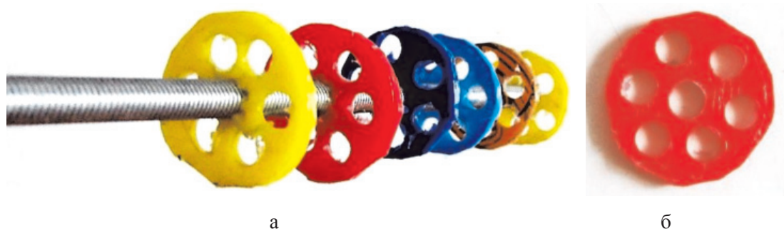
Рис. 3. Смесительная вставка с элементами, имеющими шесть отверстий: а – в сборе; б – отдельный элемент
