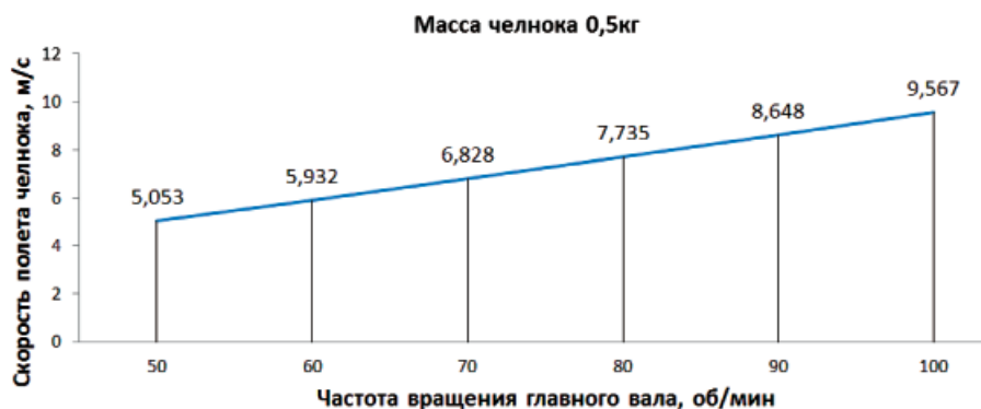
Рис. 3. График изменения скорости полета челнока в зависимости от частоты вращения главного вала ткацкого станка
