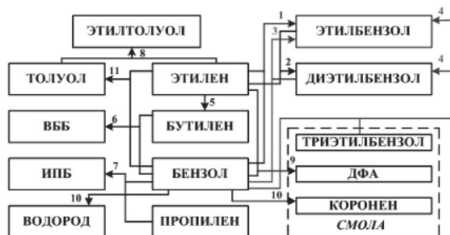
Рис. 1. Формализованная схема превращений в процессе алкилирования
