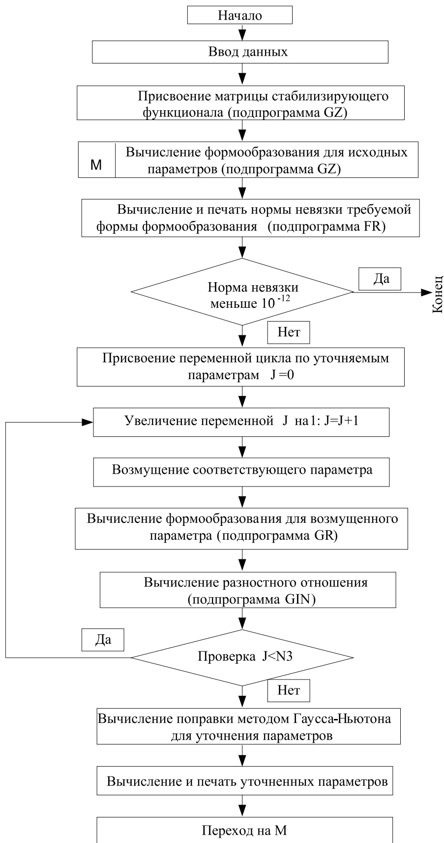
Рис. 3. Алгоритм расчета профиля катода-инструмента и распределения параметров по длине межэлектродного зазора
