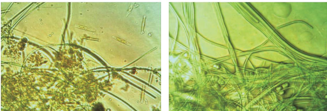
Рис. 2. Зеленые, диатомовые и сине-зеленые водоросли поврежденных поверхностей строительных изделий
