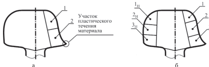
Рис. 1. Схема вырезки образцов (плоскость шлифа совпадает с плоскостью рисунка): а – для металлографических исследований; б – для рентгеноструктурного анализа
