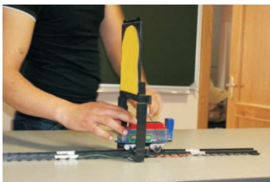
Рис. 4. Устройство, автоматически открывающее ворота при подъезде к ним вагонетки с углем и закрывающее их после её прохождения
