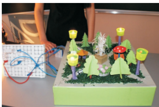
Рис. 5. Устройство, включающее фонари на улицах города при наступлении темноты и выключающее их с восходом солнца.
