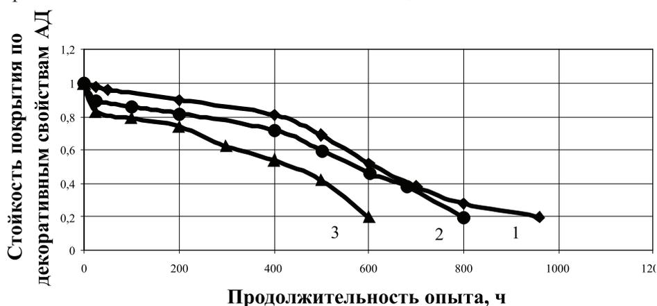
Рис. 1 – Изменение декоративных свойств огнезащитных составов: 1 – огнезащитный состав «Казантикор-У»; 2 – состав «Берлик»; 3 – состав ВПМ-2
