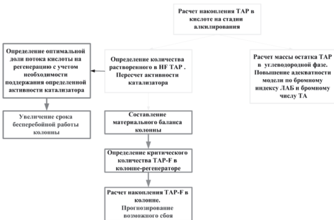
Рис. 2. Алгоритм оптимизации совместной работы системы «реактор-регенератор»
