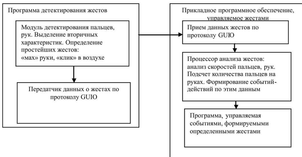
Рис. 2. Диаграмма взаимодействия «распознавателя» и прикладного программного обеспечения в интерфейсе бесконтактного управления
