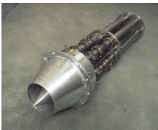
Рис. 3. Импульсно-детонационный двигатель (ИДД) традиционной схемы с пакетом детонационных труб в качестве резонаторов
