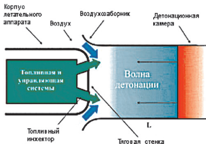
Рис. 2. Принципиальная схема импульсно-детонационного двигателя (ИДД)
