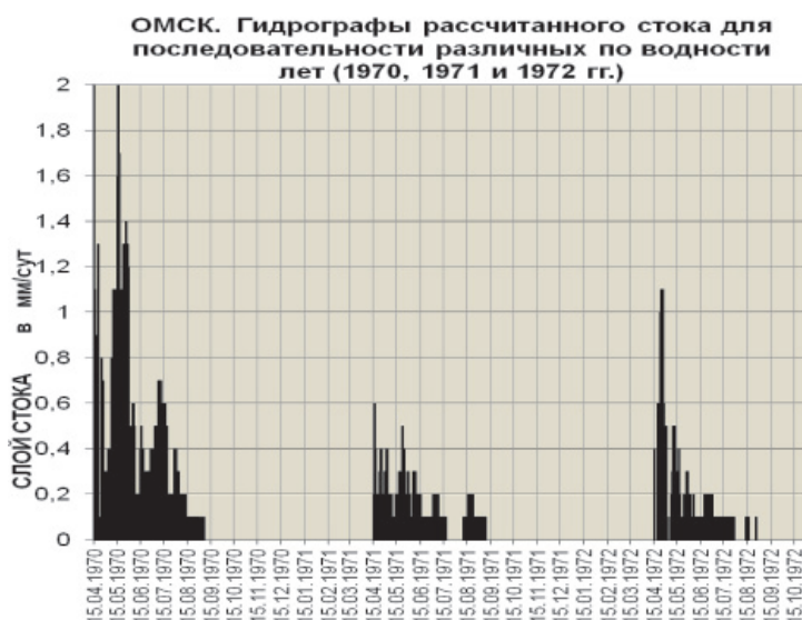
Рис. 5. Гидрограф рассчитанного суточного стока суммированного по месяцам для последовательности различных по водности лет
