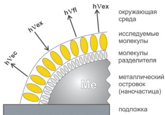
Рис. 1. Схема оптических процессов вблизи наноструктурированной поверхности металла
