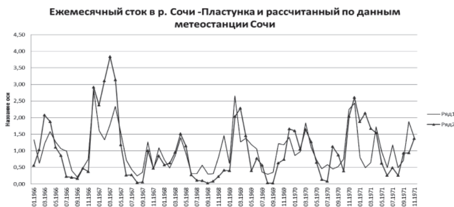
Рис. 4. Сравнение рассчитанного и измеренного стока в районе г. Сочи: ряд 1 – измеренные в р. Сочи у с. Пластунка относительные средние месячные расходы воды; ряд 2 – рассчитанные по водному балансу для метеостанции г. Сочи относительные средние месячные слои стока
