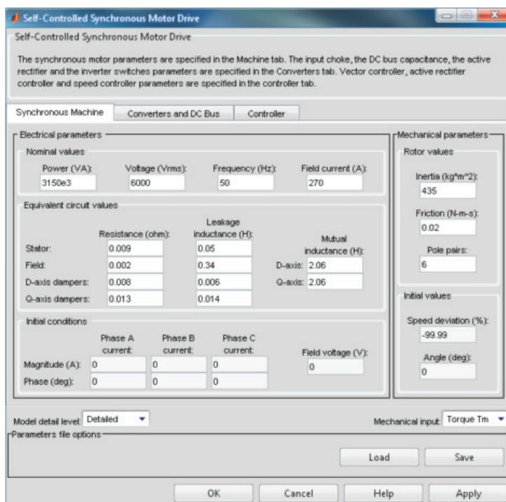
Рис. 3. Окно параметров синхронного двигателя
