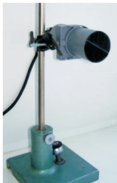
Рис. 4. Внешний вид лабораторного макета фотоэлектрического датчика
