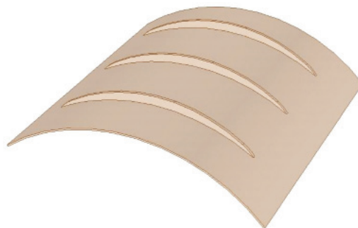
Рис. 3. Вид расчетной области для реальной колодки с 3 тангенциальными бороздками
