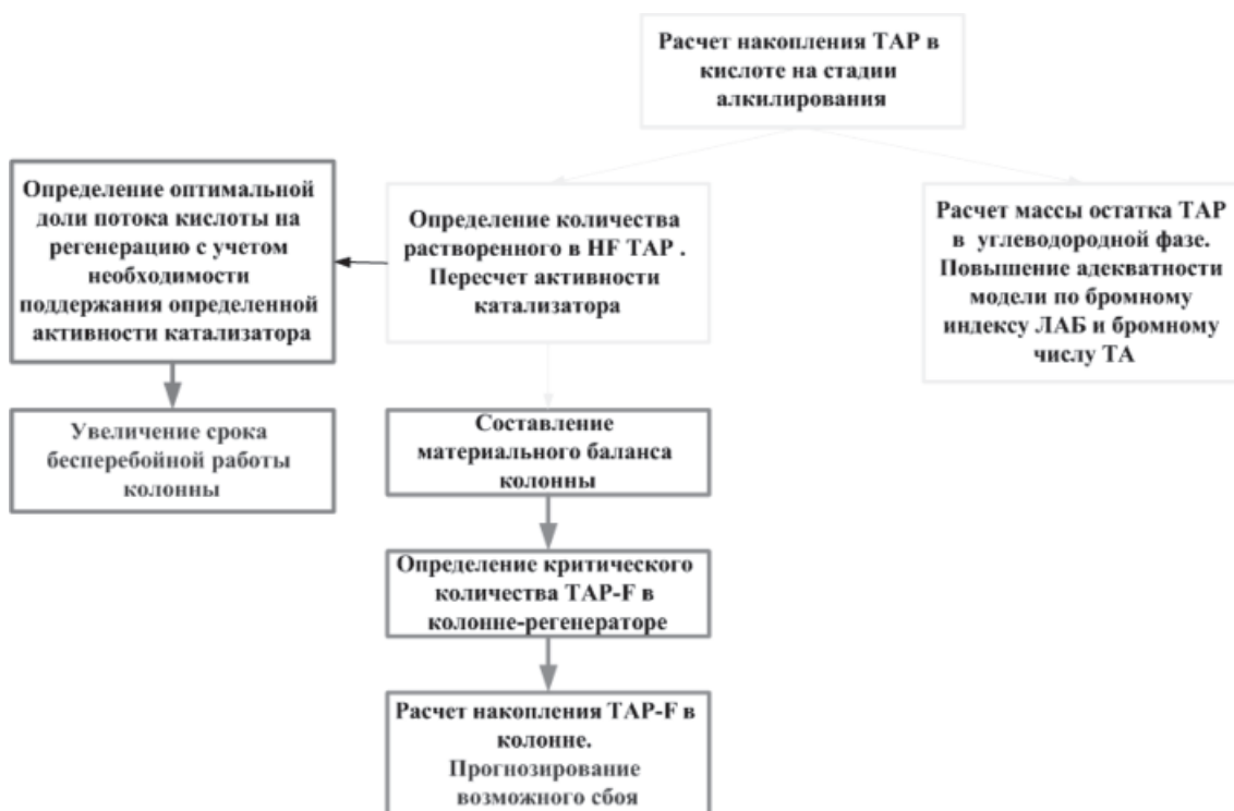
Рис. 2. Алгоритм оптимизации совместной работы системы «реактор-регенератор»
