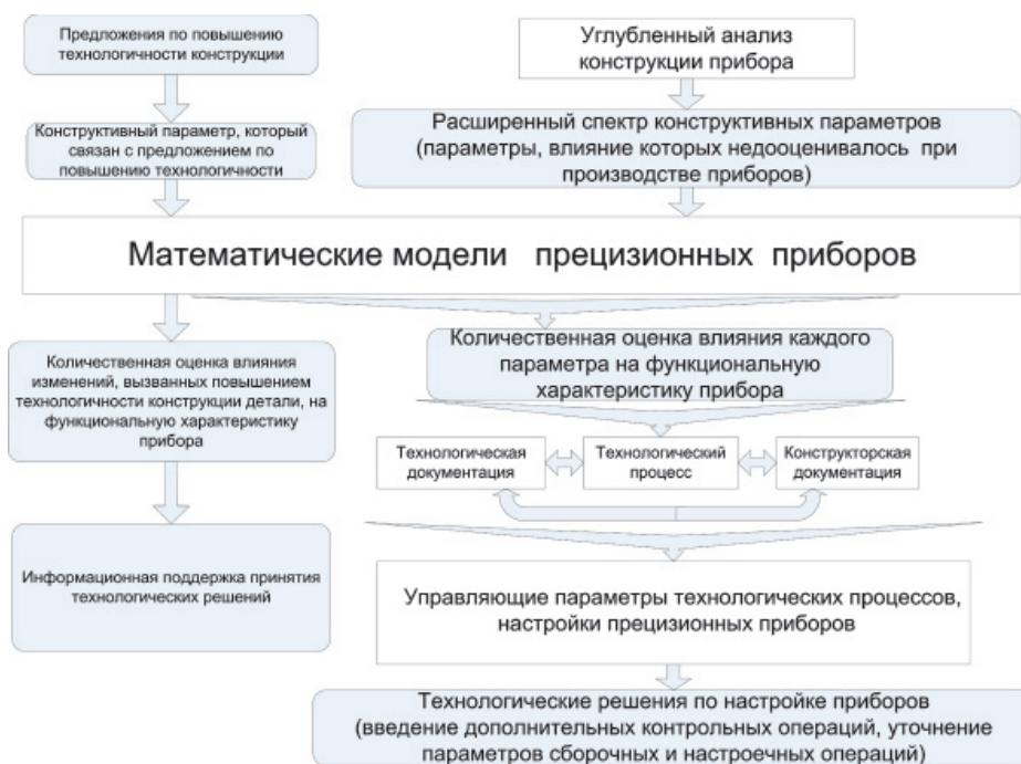
Рис. 1. Алгоритм построения и применения математических моделей, использующих расширенный спектр конструктивных параметров
