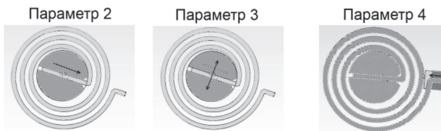
Рис. 3. Смещения пружины относительно вала датчика
