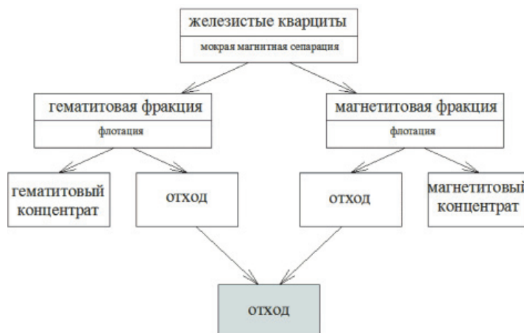
Рис. 1. Схема образования отходов обогащения железных руд
