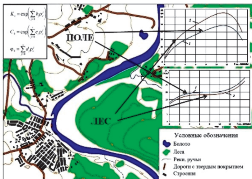
Рис. 3. Характерный участок с разными типами ландшафта, с примерами изменения глубины и плотности на поле и в лесу, и зависимостями для определения остальных характеристик снега
